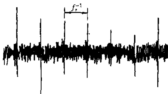
图 7-34 局部有异常的齿轮发生的振动
