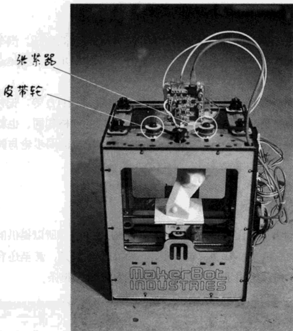
图7.40 带张紧器的MakerBot同步带系统（图片经MakerBot实业公司允许使用）
