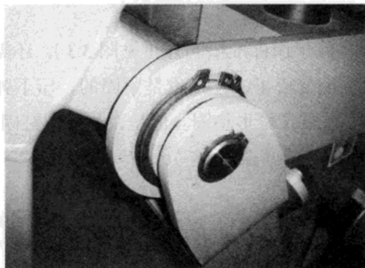
图3.10 健身器材上的弹簧卡环（定位枢轴连接的轴）
