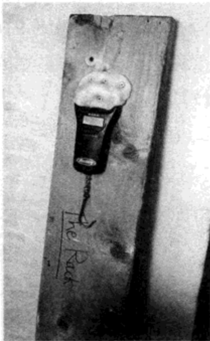
图4.13 MakerBot 实业公司用行李秤测量电机的拉力
