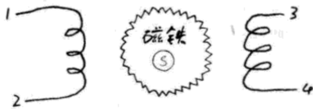
图6.35 双极步进电机的示意图
