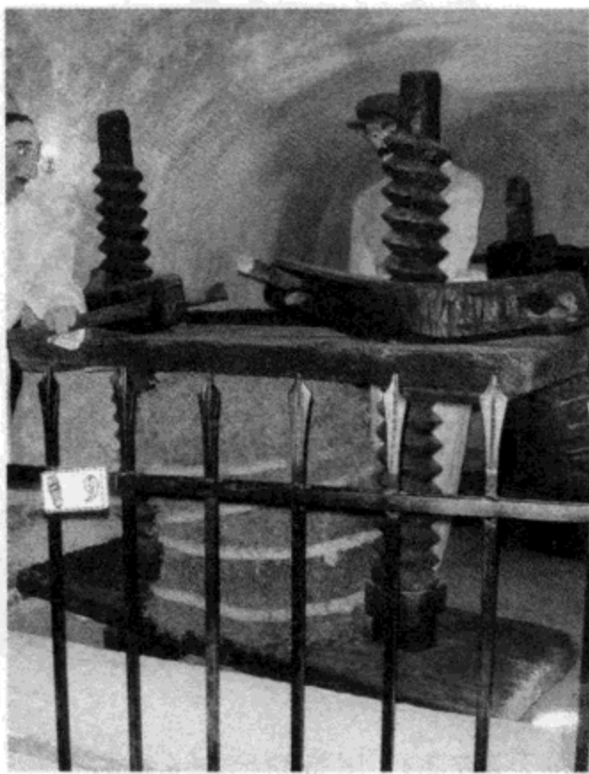
图7.42 在葡萄酒厂博物馆的立体模型中，用来压榨葡萄汁的丝杠
