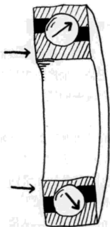
图7.10 向心止推滚动轴承可支撑径向载荷与轴向载荷
