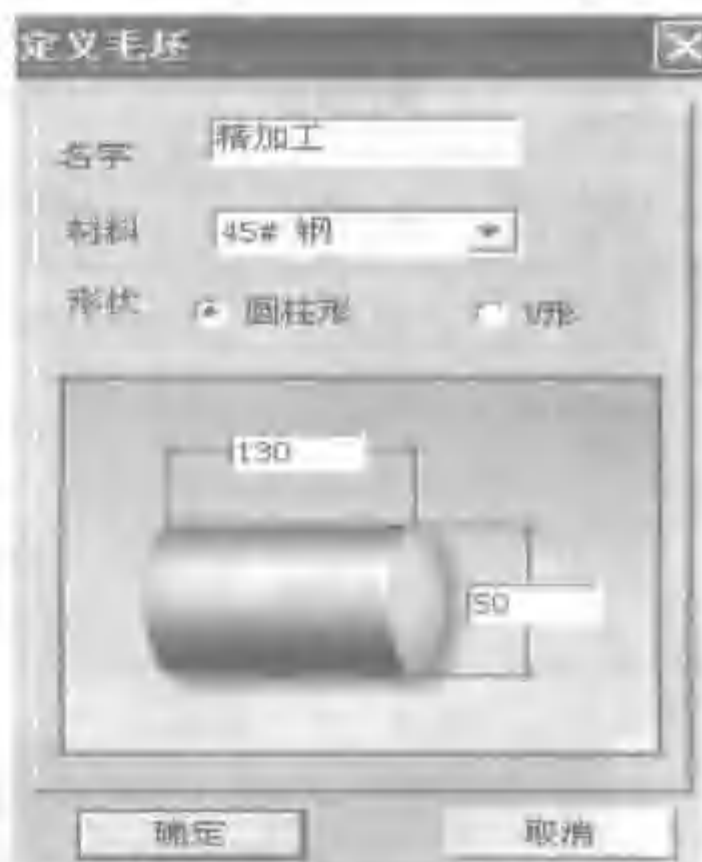
图 1-1-8 车床定义毛坯
