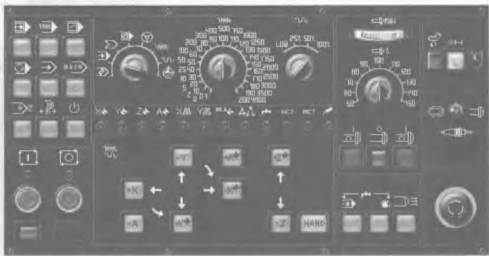
图 2-1-7 机床操作标准面板
