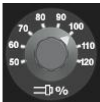
主轴转速倍率调节旋钮 调节主轴转速，调节范围从 0 ~ 120%。
