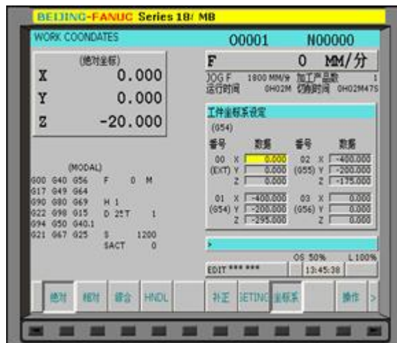
图 4.2-3 FANUC 18 i-M( 铣床 )
