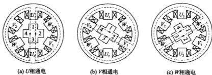
图 10-27 单相通电方式时的转子位置
