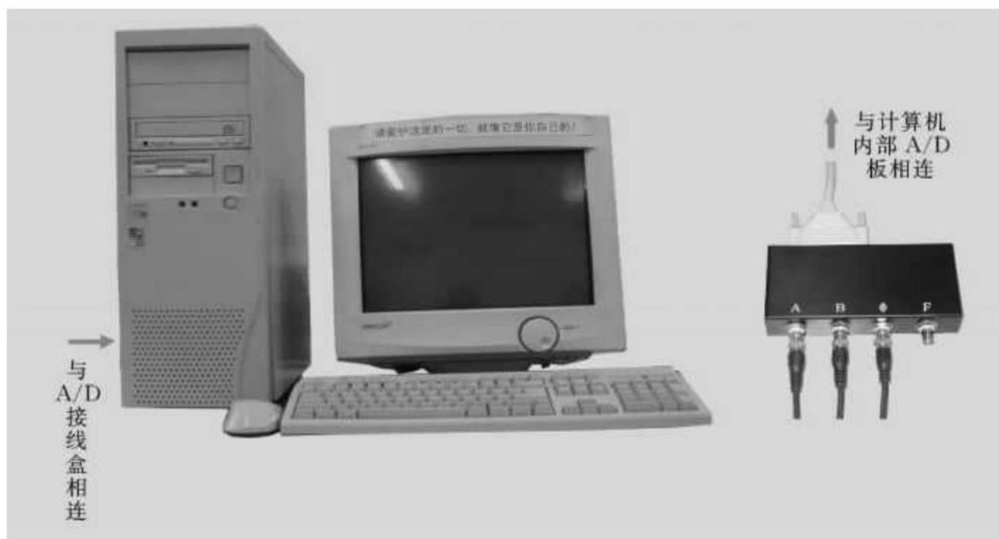
图 6-9 计算机 A/D 接线盒与计算机 A/D 板连接
