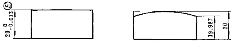
图2-1 包容原则高度尺寸公差与平面度误差
