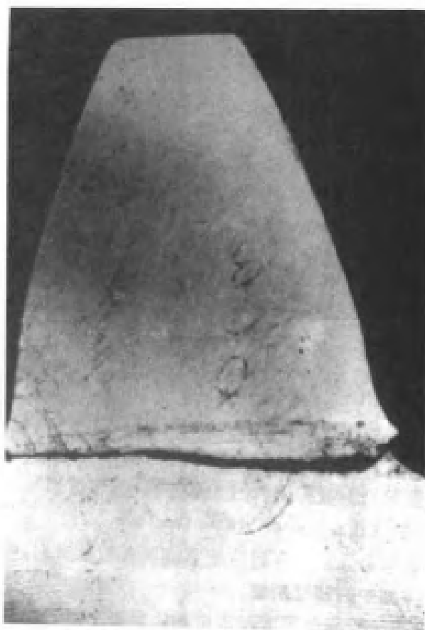
右齿面因一次严重过载的轮齿剪断(弯曲过载)。
