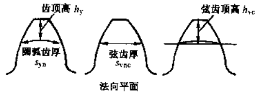
图 4-33 齿顶高和弦齿厚
