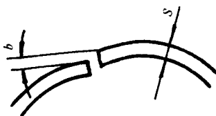
图8-25 管件焊缝的对口错边量
