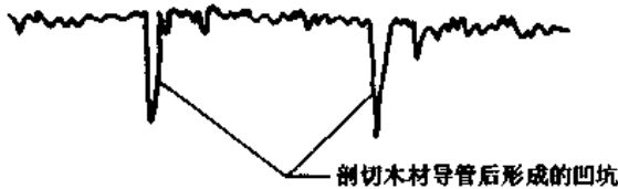
图 32-1 剖切导管形成的轮廓凹坑
