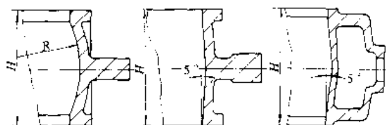
图 2-4-1 高压造型用砂箱箱壁结构形式
