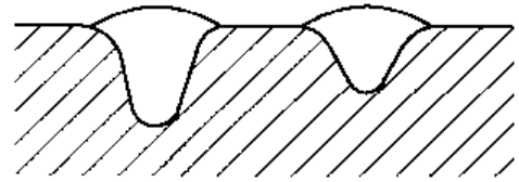
图 6.22 焊剂颗粒大小对堆焊焊缝形状尺寸的影响 (堆焊电流 420~440A; 电弧电压 34~36V, 焊速 36~38m/h)
