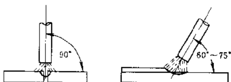
图 10-3 对接平焊的焊条角度
