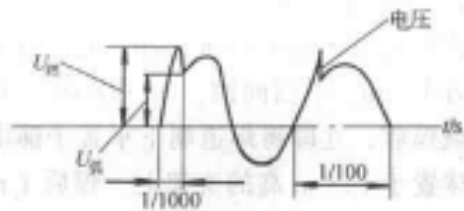
图 2-3 1/1000 s 断弧波形
