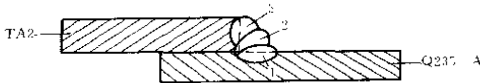
图 3 2 低碳钢与钛的焊接接头
