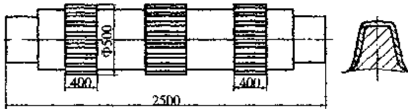
图 5-26 推压轴及花键齿形磨损示意图
