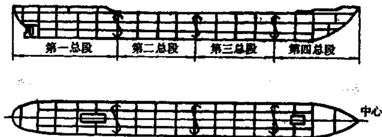
图 6-15 接总段法在船台上进行船体大合拢
