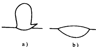
图 4-3-25 CO 2 焊短路过渡的焊缝成形
