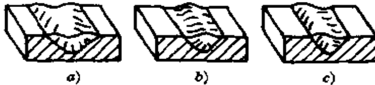
图 3-33 焊接速度对焊缝形状的影响
