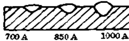
图 3-31 焊接电流对焊缝形状的影响
