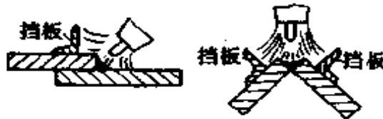
图4-17 氩弧焊临时挡板的位置
