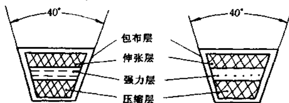
图 7-4 V带结构示意图
