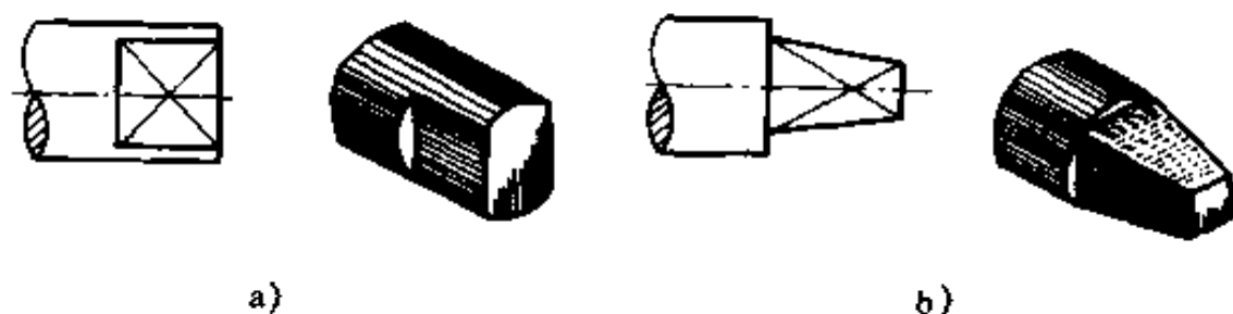
图 2-37 回转体上小平面的表示方法
