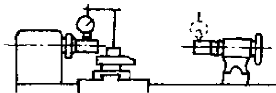
图 10-77 主轴锥孔和尾座锥孔不等高度的检验
