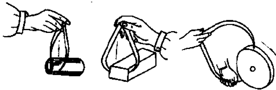
图 5-3 外卡钳测量法
