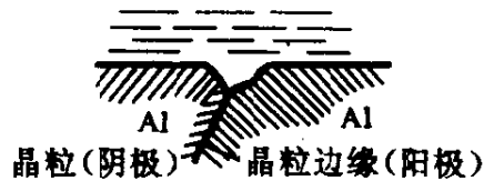
图 4.14 金属晶粒与晶粒边缘形成的微电池
