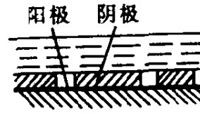
图 4.16 金属表面膜由于不完整 而形成的微电池
