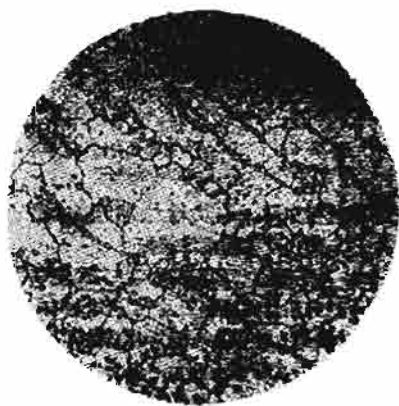
图 3-48 W18Cr4V 钢晶粒度的不均匀长大 ( \times 500 , 4%硝酸酒精浸蚀)
