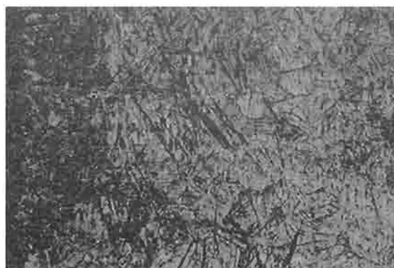
图 2-19 中碳钢过热引起的淬火裂纹
