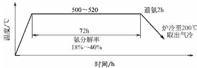
图 5-23 38CrMoAl 钢制精密磨床主轴等温渗氮工艺曲线
