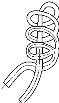
图 4-2 小尺寸工件内孔埋水淬火感应器的示意图
