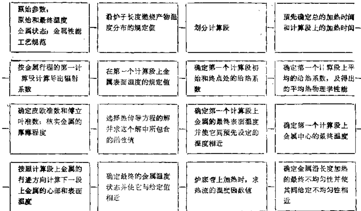
图 2-2 推钢式加热炉中金属加热的计算方法
