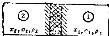
图66 存在中间层的热接触
