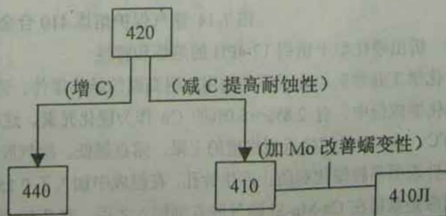
图 7-13 马氏体系和铁素体系不锈钢的系统图
