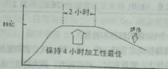
图 7-17 司太立 6 合金的去除应力热处理
