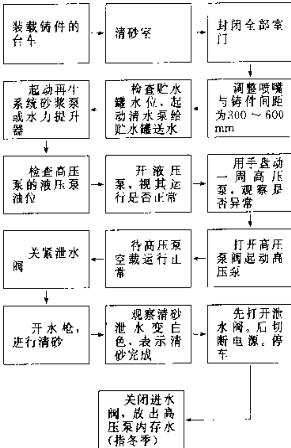
图 7-6 水力清砂操作程序
