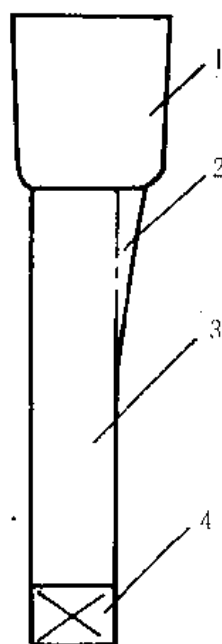
图 2-28 冒口补贴冷铁的应用
