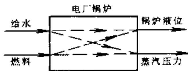
图 7-37 发电厂锅炉系统示意图
