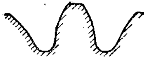
(b) 圆底齿(应力集中系数 1.7)
