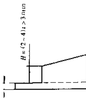
图 6-18 直边侧面带斜边 的弯曲件
