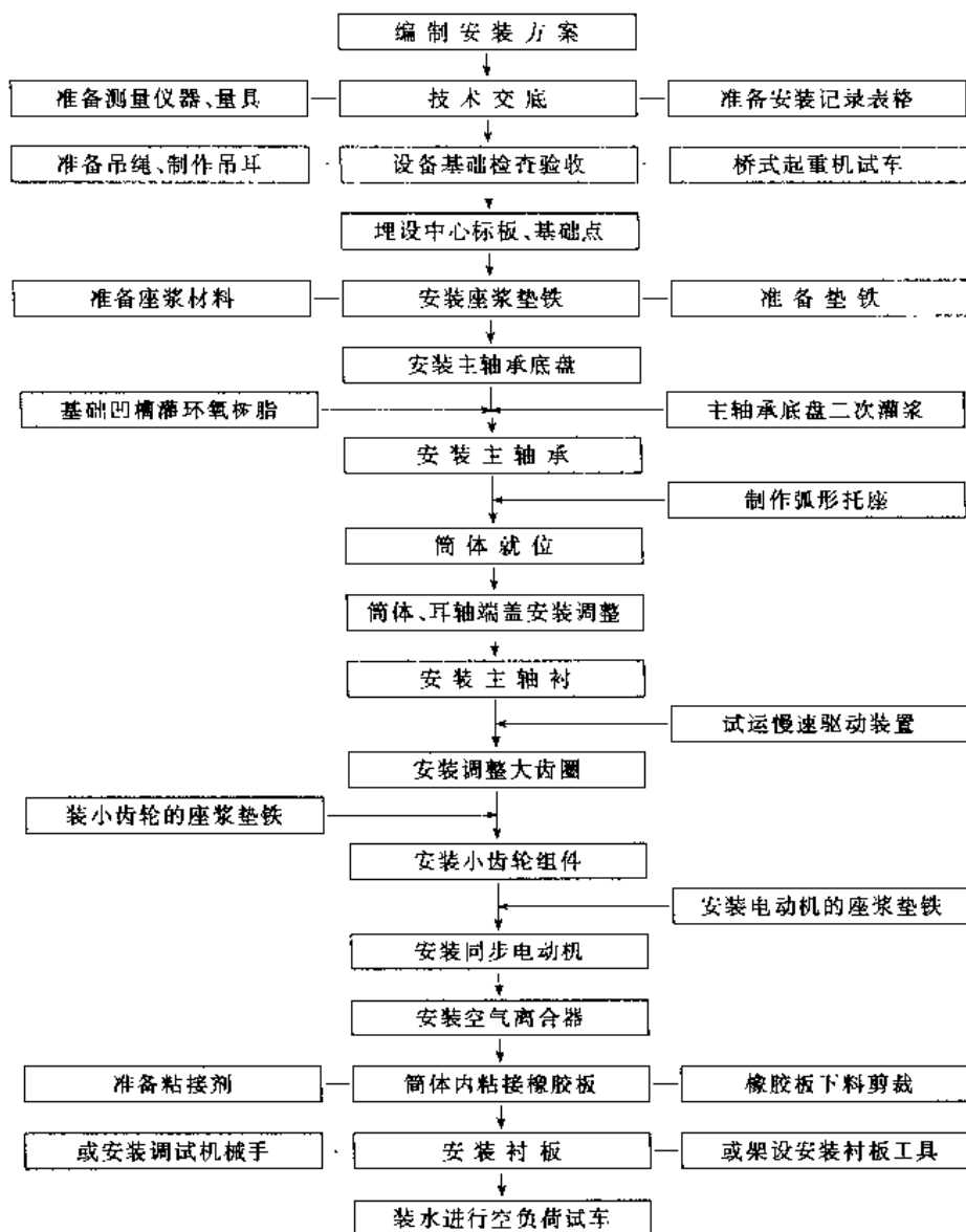
图 8-92 磨矿机安装工艺流程
