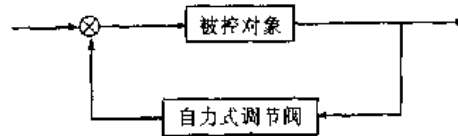
图 8.8-2 自力式调节阀组成的单回路控制系统
