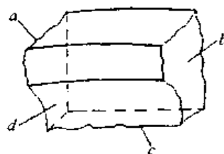
图 16.5-12 深沟球轴承外圈碎块
