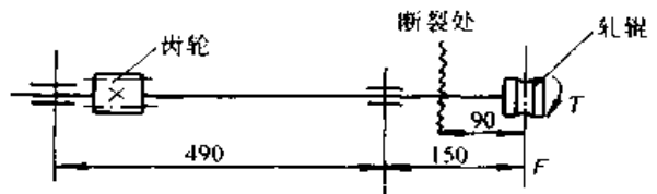
图 16.3-12 辊轴简图和断裂处
