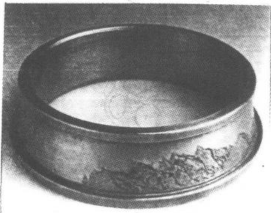
图 16.5-1 轴承内圈大端滚道表面剥落
