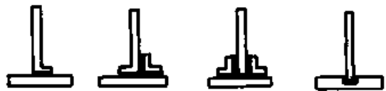
图 22.5-15 改进型 T 形接头
