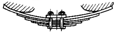
图 23.7-12 一种变刚度弹簧
