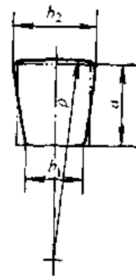
图 23.15-2 热轧梯形弹簧钢截面
