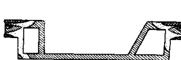
图 30.3-52 铸造立柱第二种工况导轨横截面主应力分布最大应力为 3.34 \text{ MPa}
