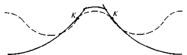
图 35.2-18 顶部摆线与工作齿形两次相交
