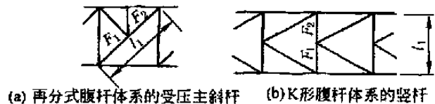
图 19-4-23 受压腹杆压力有变化的桁架简图
