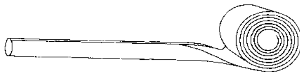
图 2-4-131 利用复合材料带自动形成刚性管
