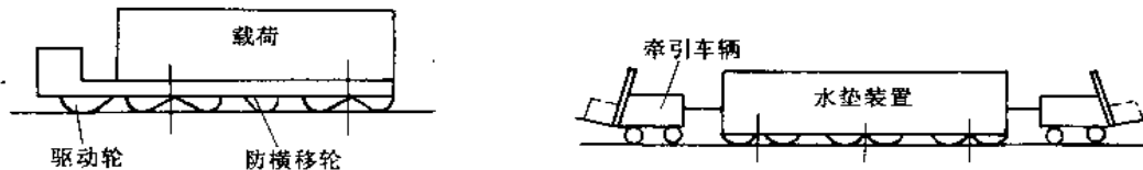
(a) 自行式气垫车的防横移轮 (b) 重型水垫装置的防横移牵引车
