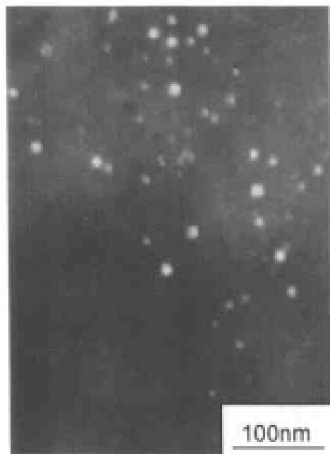
图 3-10 激光重熔, 合金成分 Al-12Si-1.23Cu-1.0Fe-0.5Mn-0.93Mg-0.1Re 合金, CO 2 激光, 200℃时效 6 小时, TEM 照片(暗场), 显示重熔区中的 Mg 2 Si 相(球状)
