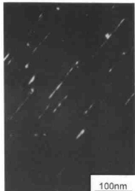
图 3-8 激光重熔, 合金成分 Al-12Si-1.23Cu-1.0Fe-0.5Mn-0.93Mg-0.1Re, CO 2 激光, 200℃时效 6 小时, TEM 照片(暗场), 显示重熔区中的 CuAl 相(条状)
