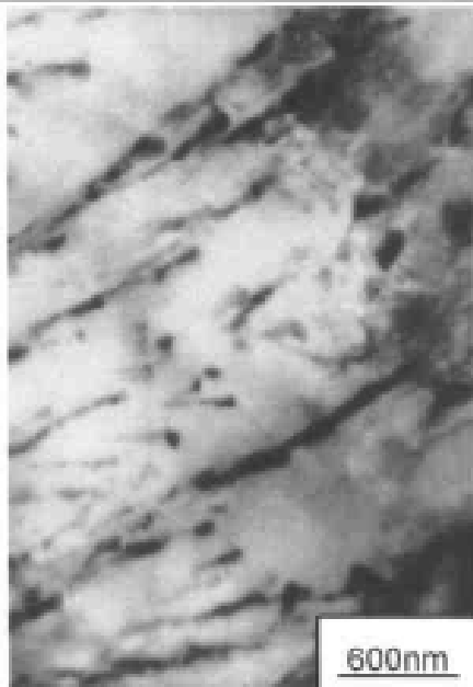
图2-16 激光相变硬化, Fe-1.0C合金(T10钢), CO 2 激光, TEM照片, 显示热影响区珠光体
