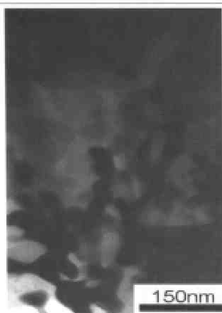
图4-32 激光熔覆,铝基体,镍熔覆材料,YAG激光,TEM照片,显示析出相,扫描速度2.5mm/s,脉宽4ms,频率8Hz,功率密度 6.46 \times 10^8 \text{ W/m}^2
