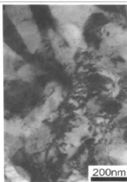
图4-33 激光熔覆,铝基体,镍熔覆材料,YAG激光,TEM照片,显示析出相和位错,扫描速度2.5mm/s,脉宽4ms,频率8Hz,功率密度 6.46 \times 10^8 \text{ W/m}^2
