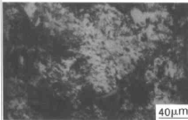
图4-52 激光熔覆，灰铸铁基体显微组织 化学成分：3.0C-1.52Si-1.01Mn-0.06S-0.08P
