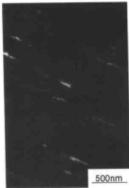
图 2-4 激光相变硬化, Fe-0.2C 合金(20# 钢), CO 2 激光, TEM 照片(暗场), 显示激光硬化区板条马氏体中间的残余奥氏体组织
