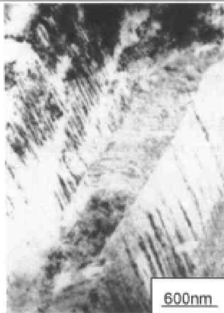
图2-14 激光相变硬化, Fe-1.0C合金(T10钢), CO 2 激光, TEM照片, 显示激光硬化区孪晶组织
