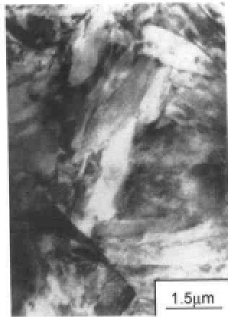
图 2-5 激光相变硬化, Fe-0.2C 合金(20# 钢), CO 2 激光, TEM 照片, 显示激光硬化区中的贝氏体组织
