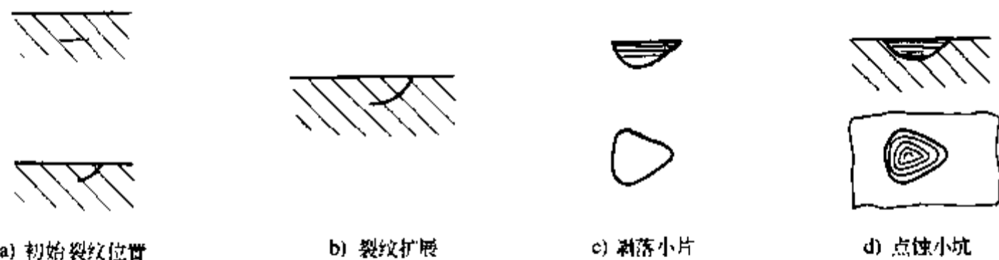
图 2.11 点蚀的形成过程
