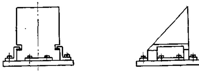
图6-35 压板压在非工作面的槽上
