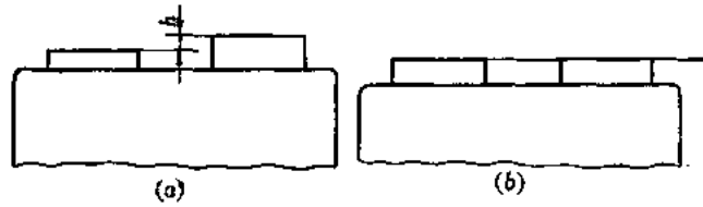
图20-9 平行凸起尽量高度一致
