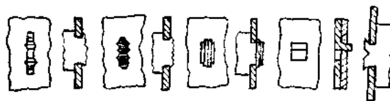
图5-32 开槽减小铆接力的结构
