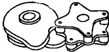
图1-8 平行分度凸轮机构
