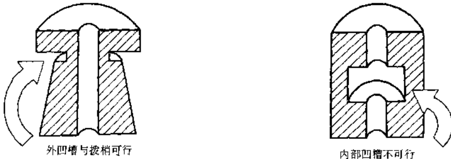
图 2-23 外部凹槽很容易在金属注射成形(MIM)零件上成形。可是,模具必须使凹槽表面有二条相隔 180^\circ 的分型线
