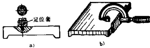
图 6-4 定位套的安装与调整
