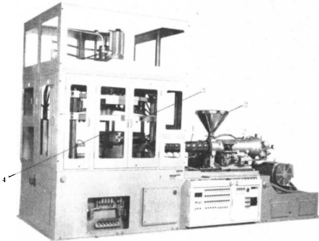
图 8-15 聚酯瓶一步法使用的设备
