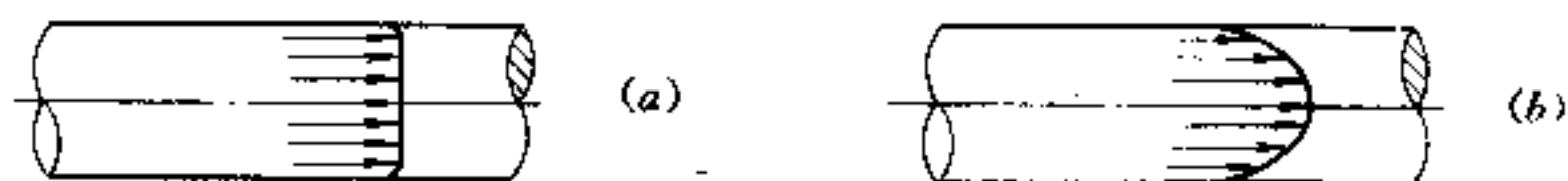
图 6.1-1 热固性塑料与热塑性塑料充模时流速分布比较
