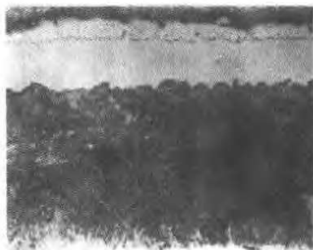
图 6.12-40 T10 钢气体渗铬层的组织, 碱性高锰酸钾溶液染色, 500×
