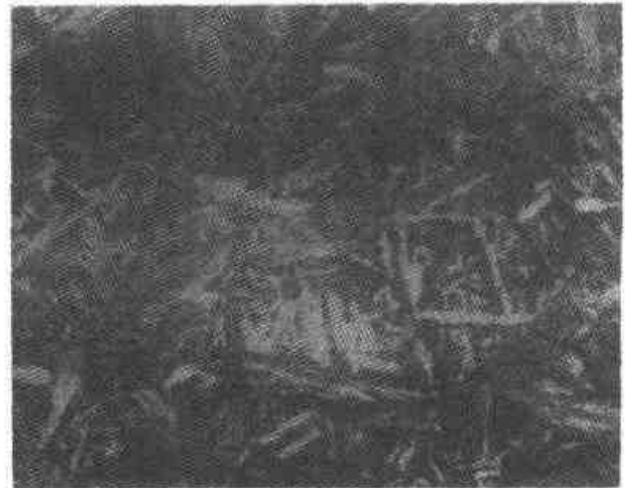
图 6.2-39 GCr15 钢 1 050℃ 固溶，300℃ 等温处理后的下贝氏体组织，500×
