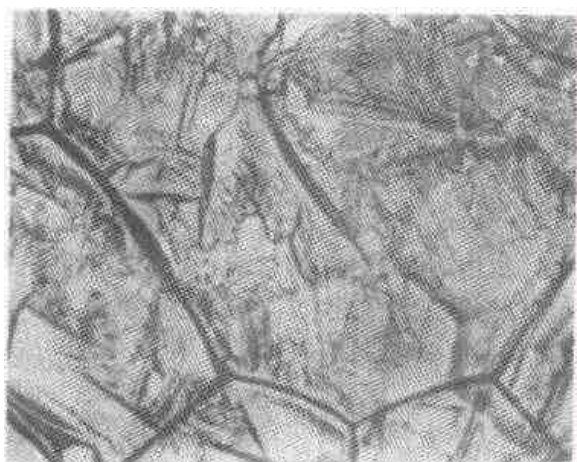
图 6.12-21 低碳钢气体渗铬层表面形貌, 100×
