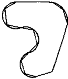
图 1.7-13 零件图形的多边形化
