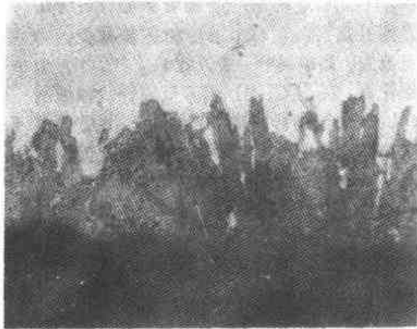
图 6.11-8 45 钢的单相渗硼层和指状碳化物 硼针择优取向明显。P.P.P. 试剂染色，300×
