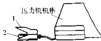
图 21.2-1 踏脚板防护罩 1—防护罩 2—踏脚板
