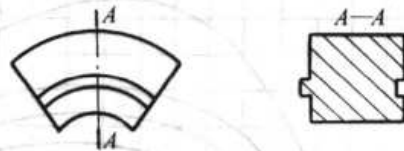
图 25.1-31 用压环固定的扇形模块
