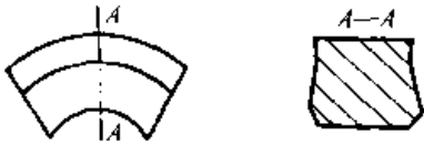
图 25.1-33 用压块固定的扇形模具
